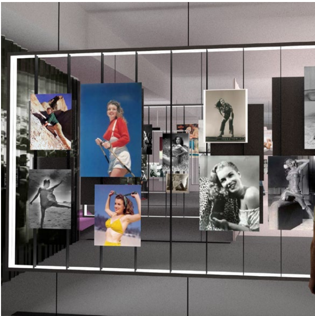
Eclairage intégré dans les cadres Les cadres suspendus auront un ruban LED de chaque côté pour les souligner et créer une sensation de flottement des œuvres. Cette éclairage sera indirect afin de ne pas créer d'ombres portées sur le sol ou sur le plafond.
