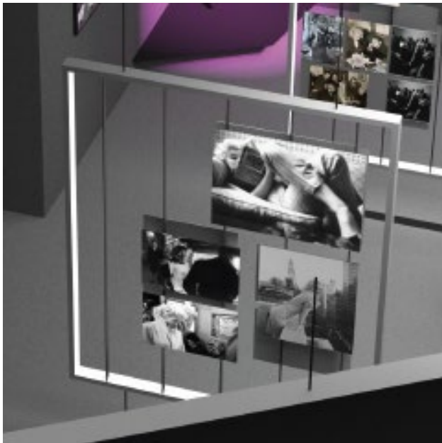
Eclairage intégré dans les cadres Les cadres suspendus auront un ruban LED de chaque côté pour les souligner et créer une sensation de flottement des œuvres. Cette éclairage sera indirect afin de ne pas créer d'ombres portées sur le sol ou sur le plafond.
